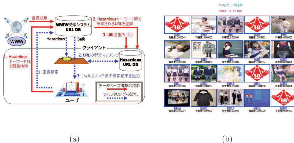
図 4.5: (a): URL パス解析に基づくフィルタリング, (b): 有害画像のフィルタリング結果
